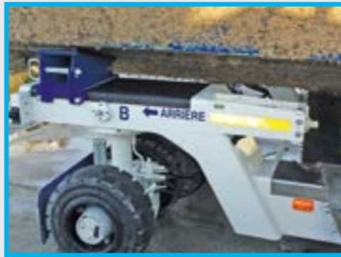
Kielstützen am Heck
