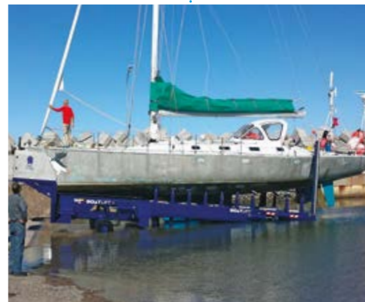
Croc Lift Anschlagmittel-System Kapazität von 15 bis 60 Tonnen Dieser amphibische Transportwagen ist sehr vielseitig, denn dank des Hebesystems mit Gurten kann er sowohl Motorboote als auch Segel- boote problemlos anheben. Das Heben erfolgt durch Teleskopstan- gen, die die Gurte spannen.
