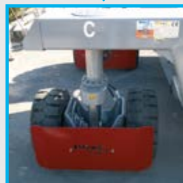
Hubsystem mit automatischem Niveauegleich, 90° Lenkung (patentiertes System)
