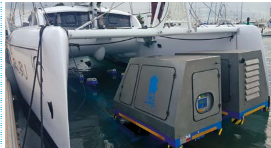
Croc Lift Anschlagmittel-System Kapazität von 15 bis 60 Tonnen Dieser amphibische Transportwagen ist sehr vielseitig, denn dank des Hebesystems mit Gurten kann er sowohl Motorboote als auch Segel- boote problemlos anheben. Das Heben erfolgt durch Teleskopstan- gen, die die Gurte spannen.
